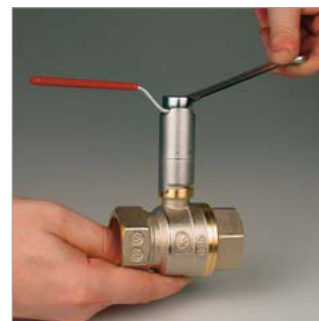
Ustaw z powrotem dźwignię i dokręć kluczem nakrętkę.
